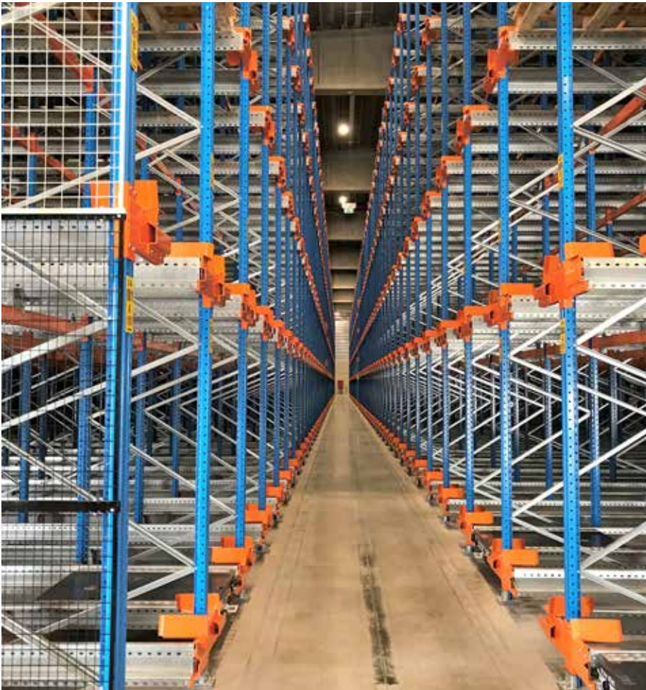
De semi-automatisering bestaat uit een smallegangenmagazijn van 70m op 100m, met een hoogte van 11,5m. Op die locatie kunnen 15.000 pallets met chemische goederen worden opgeslagen. Binnen de multidiepe rekken worden de goederen met behulp van palletshuttles aangestuurd voor in- en uitslag.
